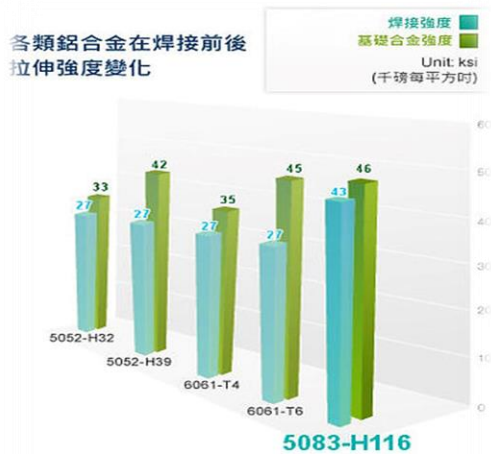
圖一、各類鋁合金拉身強度變化
