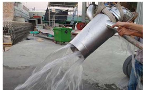
圖：錐式加壓排氣冷卻器水幕不受重力影響
