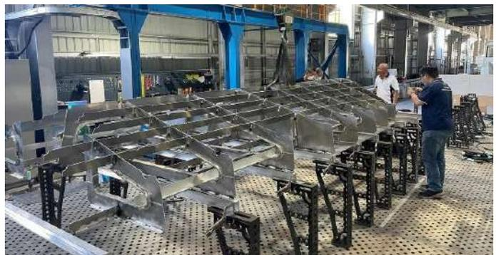
圖 3 以精密床台搭配夾治具的方式施工
