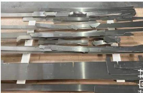
圖 2 板材以雷射切割，十分精準
