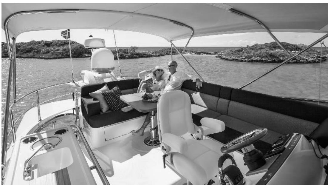
Belize 54 Daybridge 最令人著迷的地方正是其有別於前代船型的飛橋設計，配合專屬乘客席位、挑高的雅座酒吧、以及降低重心的碳纖維硬頂，讓船主能與家人享受乘風破浪的操駕快感。全船以 3D 設計規劃、掌握每個細節，精密的空間安排，甚至讓船尾可容納一艘近 10 呎的小艇。船體也採用三明治結構的複合材料，船模設計則是經過澳洲頂尖海事研究機構 Australia Maritime College, University of Tasmania 水槽測試，取得 CE Category B 認證、同時符合 RINA 結構法規，使得這艘全新設計之滑行艇，其設計需求、理論、海試、到船主實際使用，都有一致的絕佳表現。
