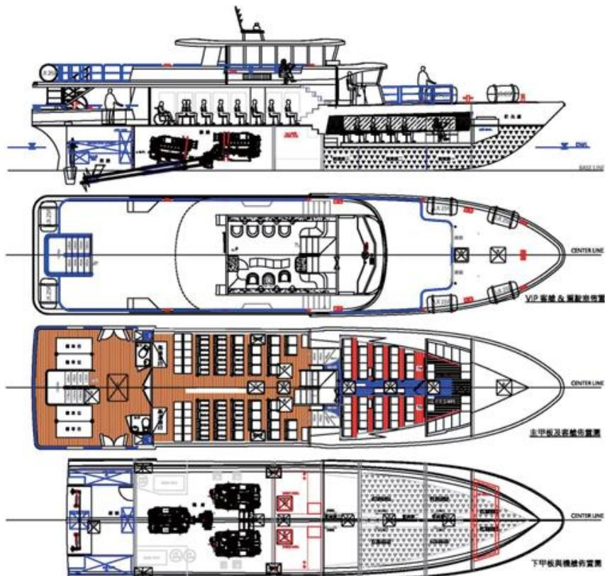
大鵬灣6號之無因次佛勞德數為1.2，於船體線型設計係採用Hard Chine船型，並搭配3部MTU 1,700 BHP 主機，達5,100匹馬力，滿載最高時速可達35節，離開灣域後一路暢行無阻，短短15分鐘即可抵達小琉球，高速舒適的航程大大降低暈船率；另配有管路防海生物附著系統及獨立式FM 200滅火系統，60HP船艏推進器提升一般客船裝備品質。
