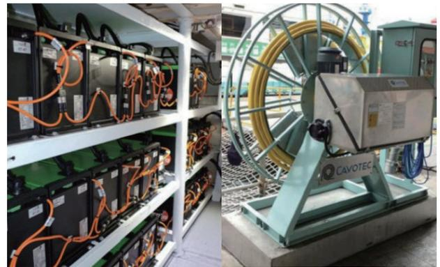
▲ 快樂號複合動力渡輪艙間動力系統及靠泊碼頭充電系統
