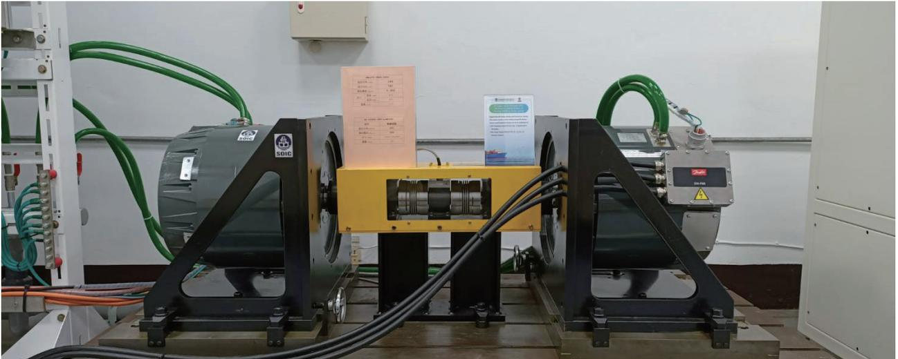
▲ 電動推進系統測試驗證平台
