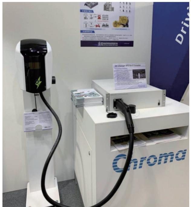
▲ 船舶中心開發的電動載具檢測系統應用於電動機車充電測試設備
