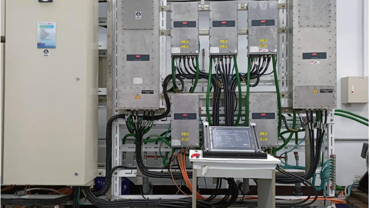
▲ 直流微電網測試驗證平台 ( 包含直流轉換器、馬達轉換器、交直流逆變器、LCL 濾波器、電源管理系統 )
