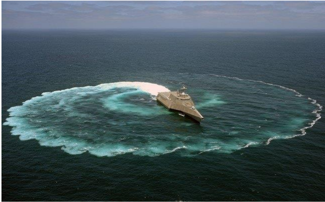
巡防艦正在進行螺旋操船測試 (圖/arronlee33/YouTube)
