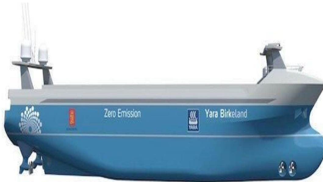
挪威的全球化肥大廠亞拉國際（Yara International ASA）與康士伯聯手設計打造「亞拉伯克蘭」號，將產品從生產據點運送至港口。這艘貨輪採用無人駕駛和純電動設計，沒有傳統的壓載艙。船上還配有一套自動靠岸系統，停泊和起航免人工操作，碼頭也無需特別安裝設備。
