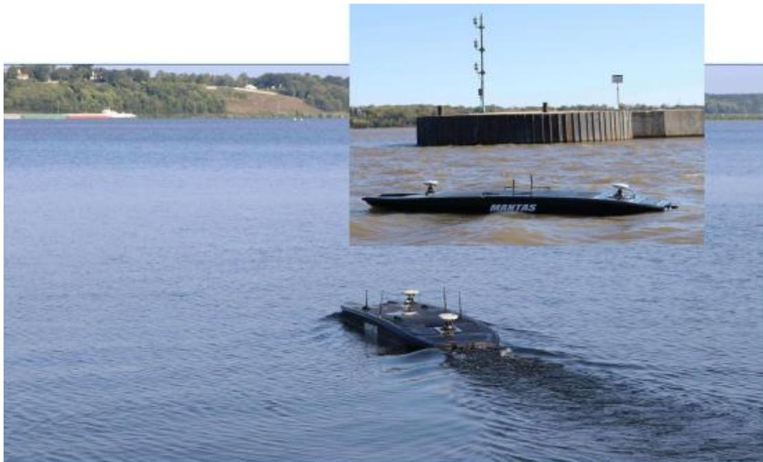
圖 1 MANTAS 無人船搭載 Teledyne RESON T20 多波束測深探測儀用於量測 Keokuk 水壩
