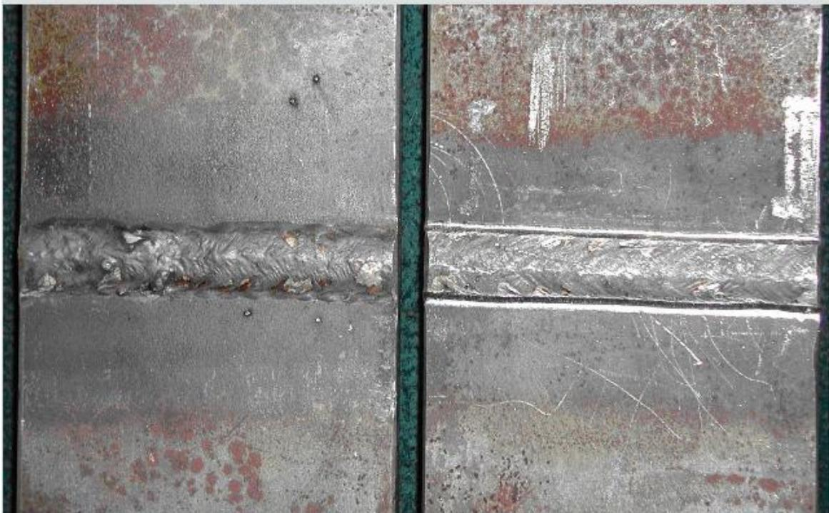
對接焊道處理前(圖左)後(圖右)之狀況
