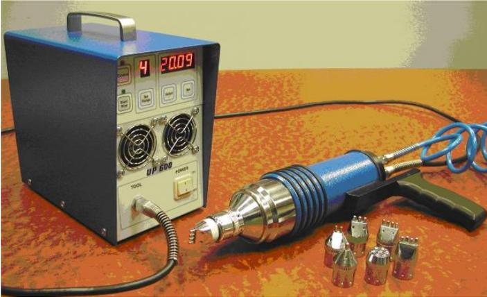
基本超音波敲擊系統
