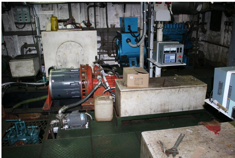
圖六 拆除引擎後安裝高效能推進用永磁馬達(Traction Motor)，機艙空間即刻獲
