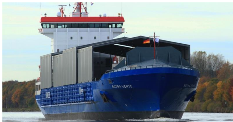
圖 2 Rotra Vente 號上可伸縮的屋頂
