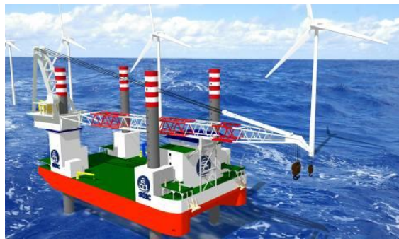
圖 2：自升式安裝船設計
