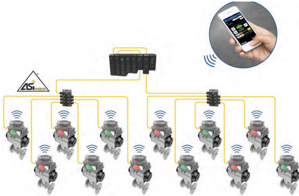
圖 2 離散式閥件控制器搭配無線網路控制示意圖
