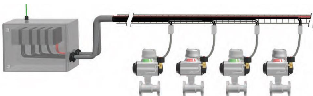
圖 1 離散式閥件控制器搭配有線網路控制示意圖
